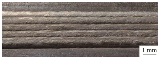
图5 不锈钢绞股焊丝堆焊试样
